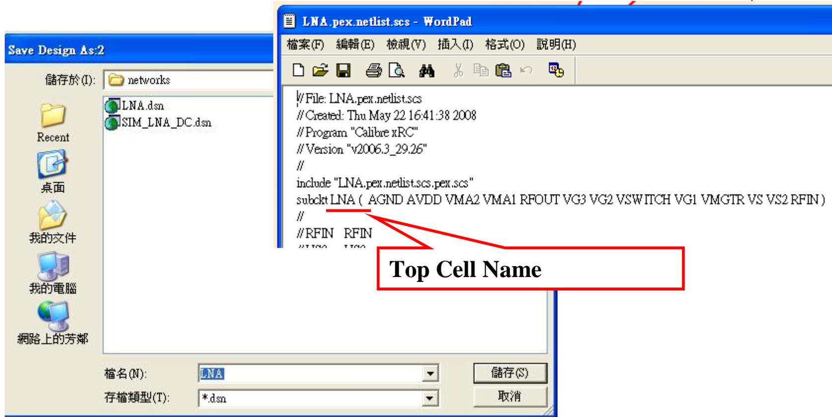
將電路圖存檔，檔名必須和Netlist的Top Cell Name一致，如範例，必須存成LNA.dsn
